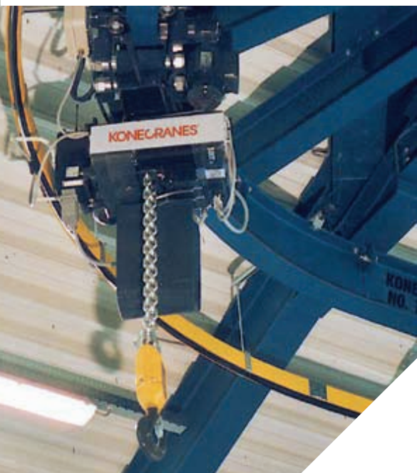
起重能力可达 5000kg的低净 空起升机构
